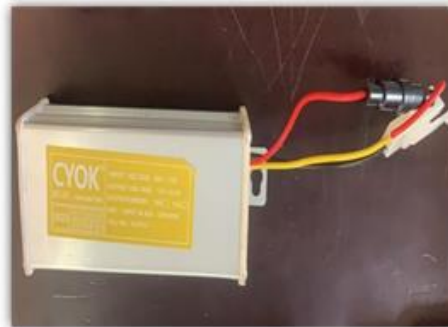
DC/DC Converter (Input Volt 36V to 72V Output Volt 12V +- 0.5V)
